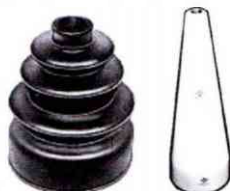
1493E kit rep. transm. l/rda para montar en cono en neopreno especial de elasticidad 800%
