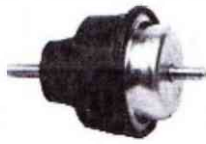
M.C.0697 HIDRAULICO (650g.) soporte motor derecho desde '89 r.o.1844.38
